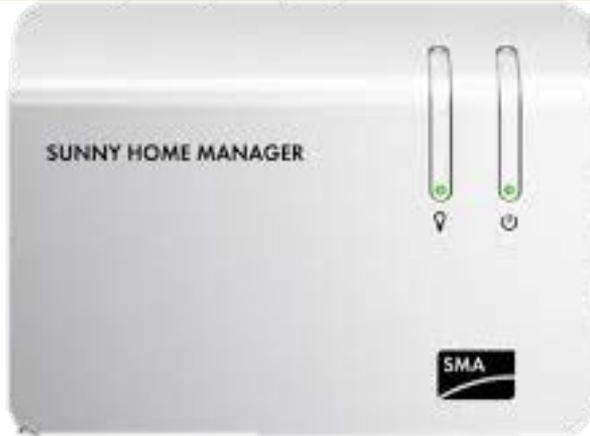
Es ist wichtig, dass der **Sunny-Home-Manager** (SHM) von SMA in den Router integriert ist, in den auch der **AMTRON®** eingebunden wird.
